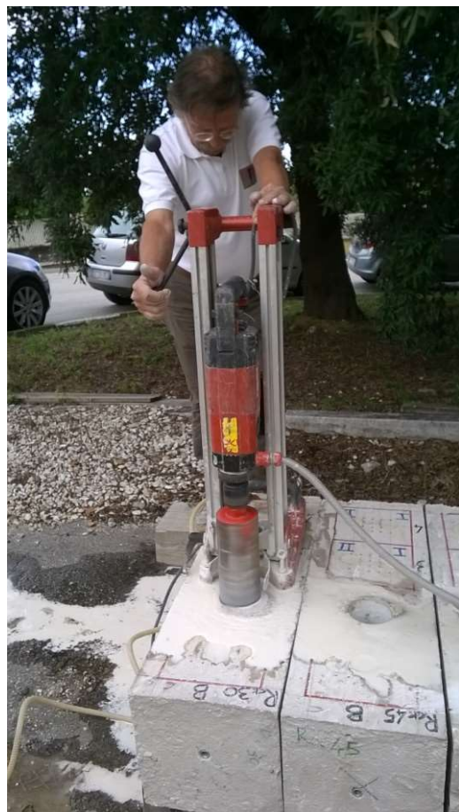
Operazione di carotaggio
