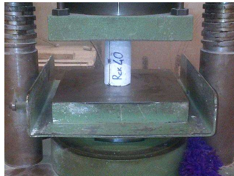
Schiacciamento provini cilindrici estratti
