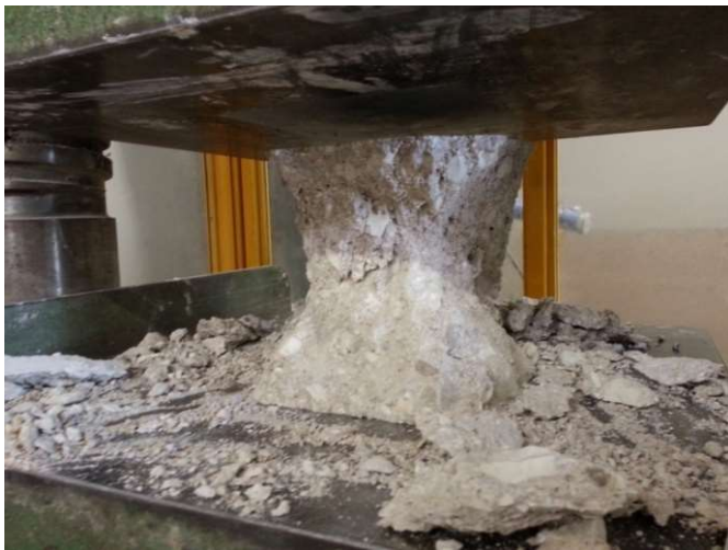
Schiacciamento provini cubici
