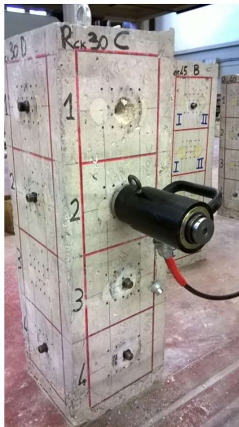
Prova di estrazione impiegando l'innovativo tassello
