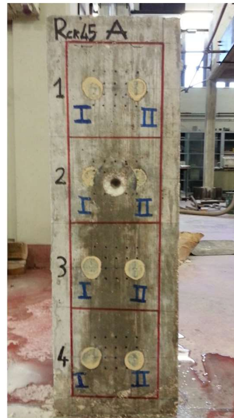
Porzione tronco-conica estratta dopo l'esecuzione della prova e punti di misura ultrasonici
