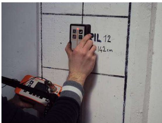
Esecuzione dell'indagine magnetometrica
