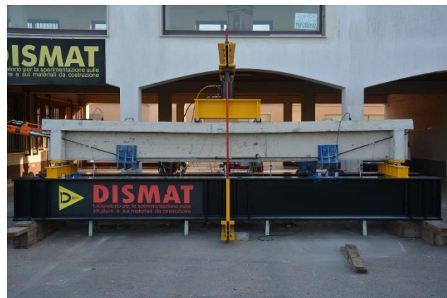
Figura 12 - DISMAT – Consolidamento mediante precompressione esterna di un impalcato di viadotto in CAP - Modello in Laboratorio
