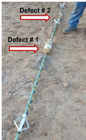
Figura 23 - riproduzione difetti su barra di tesatura
