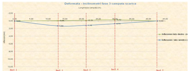
Figura 15 - Schema di carico n° 3 - Prove del Marzo 2022 e confronto
