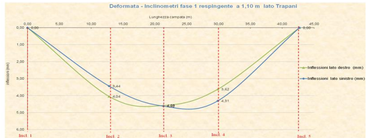
Figura 13 - Schema di carico n° 1 - Prove del Marzo 2022 e confronto
