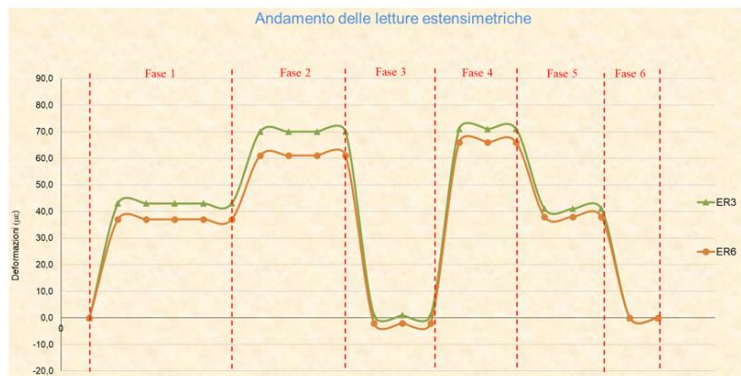
Figura 16 - Risultati dati estensimetrici della prova di Marzo 2022 e confronto
